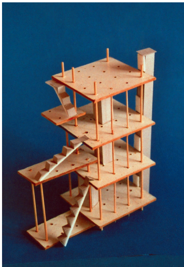
Abb. 258: Modell eines offenen wandelbaren Stützenhauses
